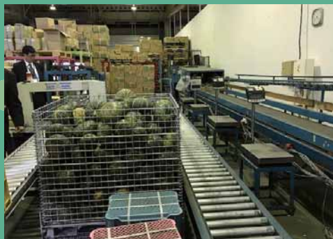
鉄コンテナによる簡易選別出荷の取り組み
