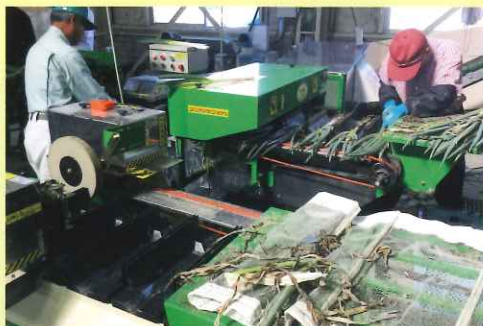
調整機導入による白ねぎ調整作業
